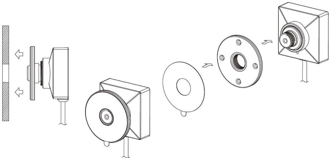
撕下一面 (c) 雙面膠布 貼上 (d) DIY 偽裝固定輔助片，再旋上 1) 鏡頭，再撕下另一面 (c) 雙面膠布 貼上偽裝物件裡層固定好
